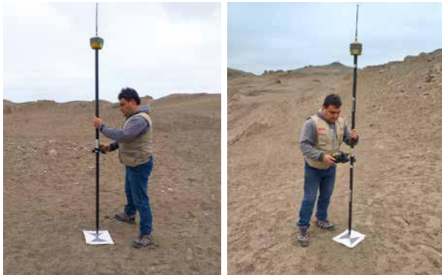
Medición de los puntos de control en el terreno con gps diferencial topcon HIPER H
